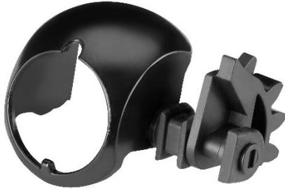
Auf Platz zwei landet ein Fußschalthebel von 2R Kunststofftechnik. Um eine Kontaktkorrosion zwischen den leitfähigen Materialien und der recycelten Kohlefaser zu vermeiden, müssen Gewindebuchsen etc. elektrisch entkoppelt werden. Dafür werden sie zunächst mit einem glasfaserverstärkten Polyamid ummantelt und danach mit Polyarylamid umspritzt. Den dritten Platz belegt ein 2K-Dichtgehäuse von ROS Coburg, das mehrere Funktionen in einem Hybridbauteil vereint.
