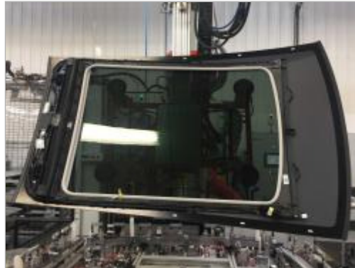
Composite Guide Rails for Roller Blind Sunroof Module - (Bild: Polyscope).
