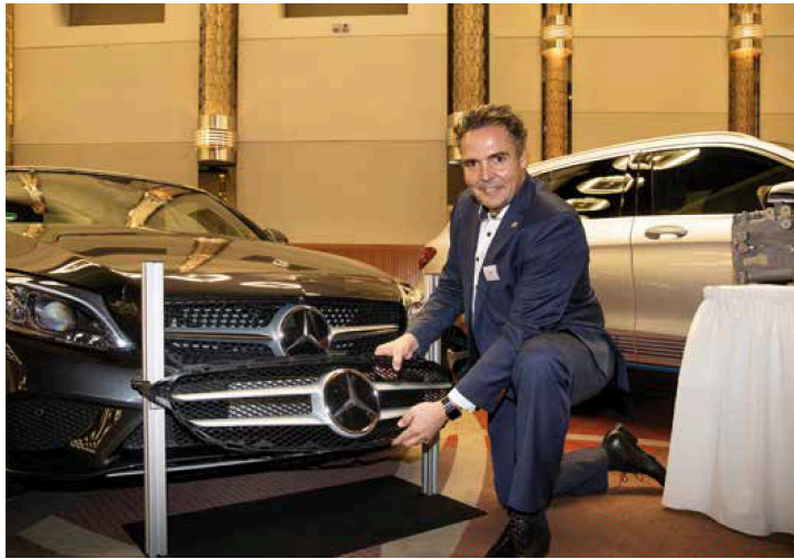
Jurymitglied Thilo Stier zeigt eine Mould-in-Colour-Lamelle von Montaplast aus PA 612 in Silbermetall, deren Class-A-Oberfläche an die Qualität lackierter Bauteile heranreicht.
